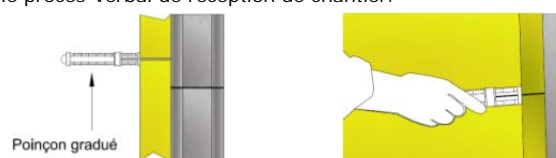
Figure 1 : Contrôle de l'épaisseur
