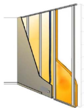
Figure 9 : Contre-cloison constituée de montants simples ou doubles sans fixation intermédiaire au support
